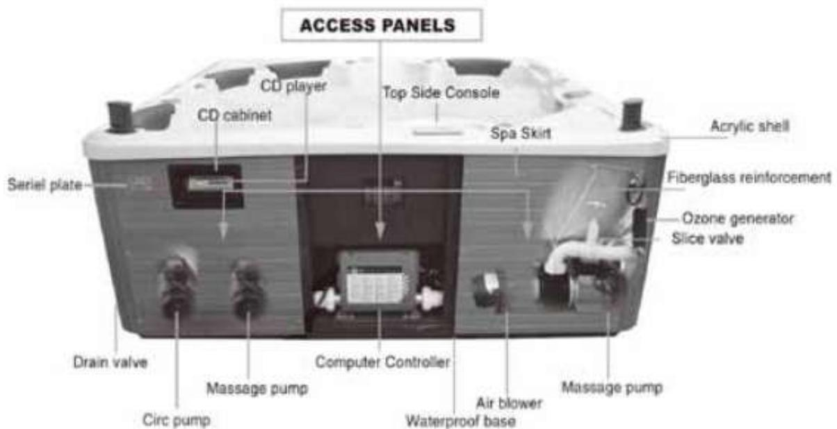
**CASCO DEL SPA (Acrylic Shell):** Superficie del spa que contiene el agua, construida de acrílico y fibra de vidrio.
